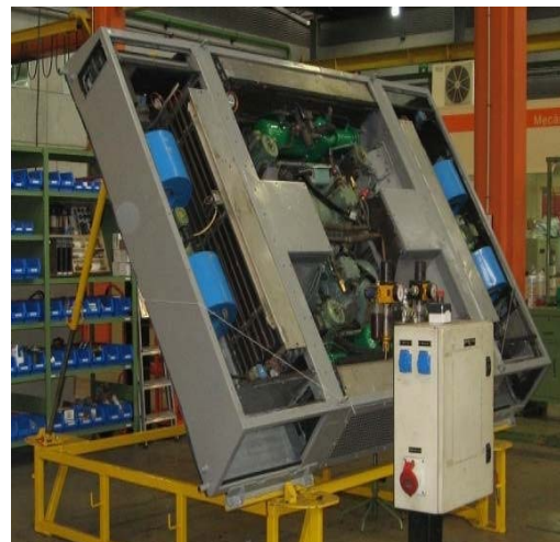
Equipos compactos de Bomba de Calor de las UT 112 / 213
